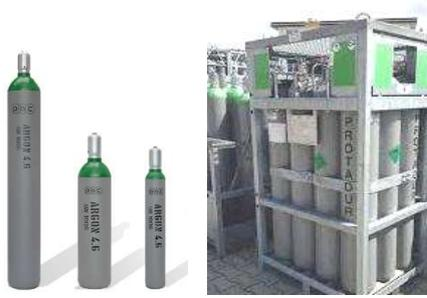
Je nach Verbrauch bietet sich die Anlieferung von Gas in 10 l-, 20 l- oder 50 l-Flaschen an, oder erfolgt in Flaschenbündeln. Der Fülldruck dieser Druckbehälter beträgt im Regelfall 200 bar, wenngleich es auch 300 bar Flaschen gibt. Durch diese hohe Komprimierung ist es möglich, große Gasmengen raumsparend zu transportieren, auch wenn unsere Gasfüllgeräte mit erheblich geringerem Eingangsdruck auskommen.
