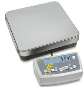
Die erreichbare Messgenauigkeit einer Volumen-Verbrauchsmessung durch Wägung (auf 1 g genau) liegt bei Argon im Bereich von 0,6 Liter, bei Krypton bei ca. 0,3 Litern und bei Xenon bei etwa 0,2 Litern, so dass über die Wägung der Gasflasche präzise Gasverlustmessungen möglich sind.
