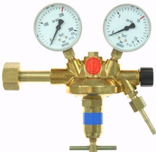
Der Unterschied zwischen einem Druckregler und einem Durchflussregler ist am zweiten Manometer leicht zu erkennen. Bei beiden Systemen dient das erste, flaschenseitige Manometer der Überprüfung des Flaschendruck und damit des Füllzustands der Flasche. Bei einem Druckregler zeigt das ausgangsseitige Manometer den mit dem Drehknebel unten eingestellten Ausgangsdruck in der aufgedruckten Einheit **bar** bzw. **psi** an.
