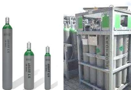
Je nach Verbrauch bietet sich die Anlieferung von Gas in 10 l-, 20 l- oder 50 l-Flaschen an, oder erfolgt in Flaschenbündeln. Der Fülldruck dieser Druckbehälter beträgt im Regelfall 200 bar, wenngleich es auch 300 bar Flaschen gibt. Durch diese hohe Komprimierung ist es möglich, große Gasmengen raumsparend zu transportieren, auch wenn unsere Gasfüllgeräte mit erheblich geringerem Eingangsdruck auskommen.
