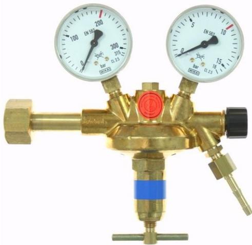
Der Unterschied zwischen einem Druckregler und einem Durchflussregler ist am zweiten Manometer leicht zu erkennen: Bei beiden Systemen dient das erste, flaschenseitige Manometer der Überprüfung des Flaschendrucks und damit des Füllzustands der Flasche. Bei einem Druckregler zeigt das ausgangsseitige Manometer den mit dem Drehknebel unten eingestellten Ausgangsdruck in der aufgedruckten Einheit **bar** bzw. **psi** an.
