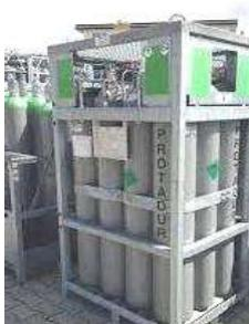
Selon la consommation, le gaz peut être livré en bouteilles de 10 l, 20 l ou 50 l ou en faisceaux. La pression de remplissage de ces récipients sous pression est généralement de 200 bars, bien qu'il existe également des bouteilles de 300 bars. Cette compression élevée permet de transporter de grandes quantités de gaz de manière peu encombrante, même si nos dispositifs de remplissage de gaz se débrouillent avec une pression d'entrée nettement inférieure.
