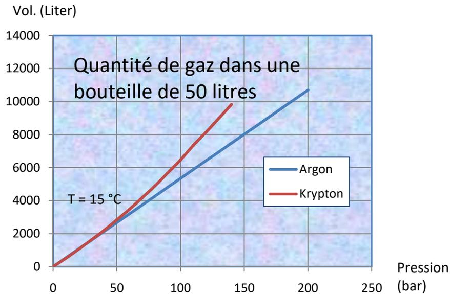
Dans le cas de l'argon, cette simple estimation sous-estime la quantité de gaz réellement présente dans la bouteille jusqu'à 7 %, et dans le cas du krypton de près de 30 %, puisque les deux gaz dans la bouteille sont gazeux à température ambiante mais seulement approximativement. Correspondent à la loi des gaz parfaits. L'écart est encore plus important pour le xénon, pour lequel ce calcul ne peut fournir qu'une estimation grossière bien en dessous de 40 bars environ.
